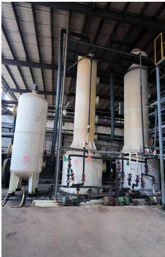
图 5.1-4 亚硝基硫酸车间工艺尾气前二级处理吸收塔
